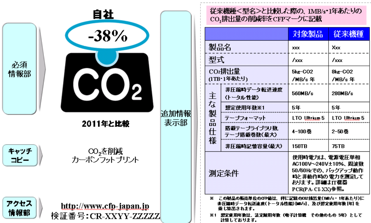
図 G-4 テープアレイ装置の CFP マークの表示例 【数値例】
