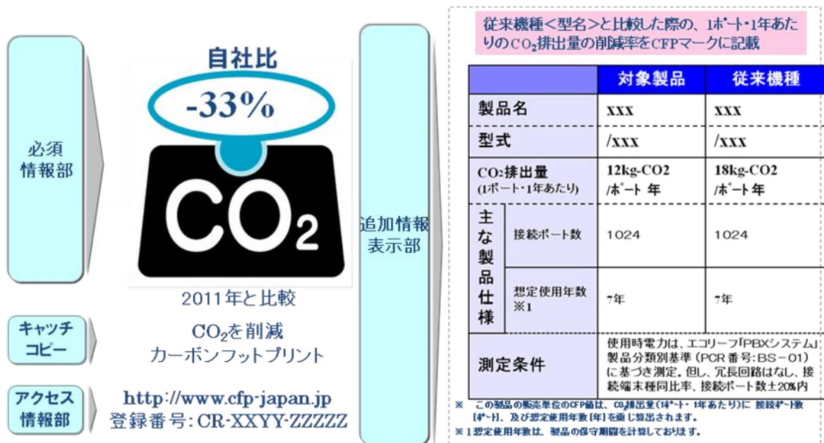
図 G-7 電子交換機の CFP マークの表示例
