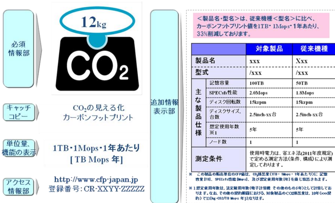
図 F-3 ファイルストレージ装置の CFP マークの表示例
