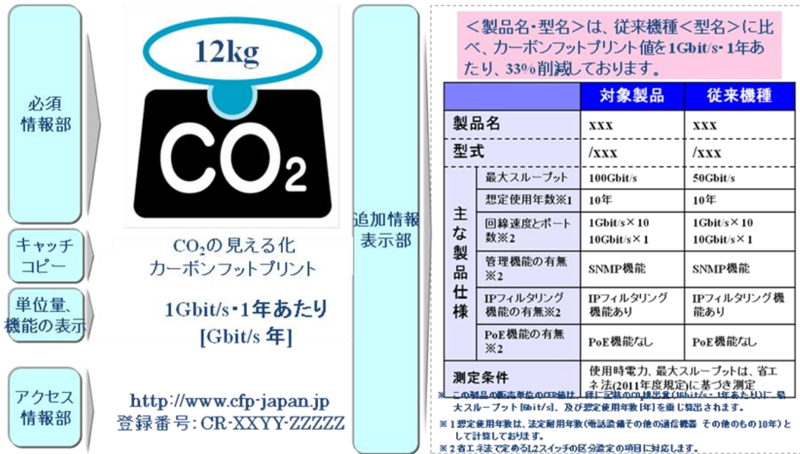
図 F-5 スwitching機器(L2スイッチ)の CFP マークの表示例
