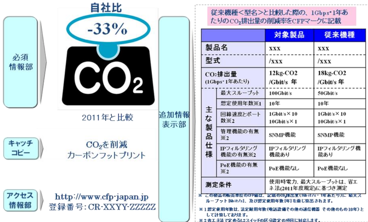
図 G-5 スwitching機器(L2 スwitch)の CFP マークの表示例 【数値例】
