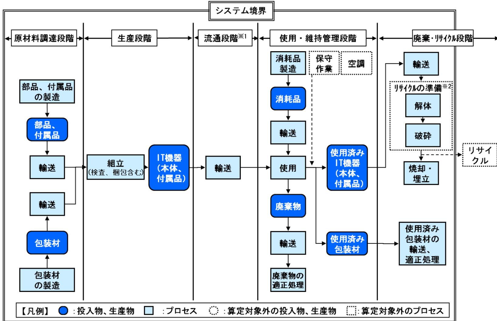
※2 リサイクルの準備プロセスまでを計上する。この CFP-PCR では「解体」「破碎」プロセスが該当する。
