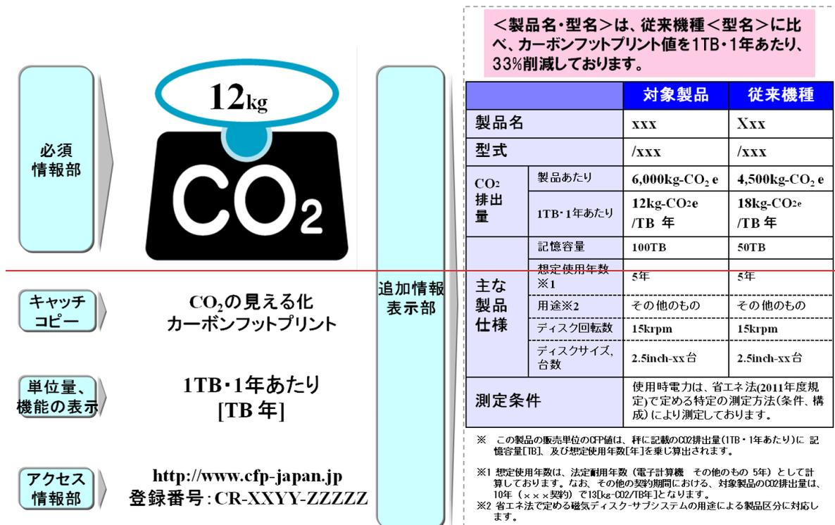
図 F-2 ディスクアレイ(磁気ディスクを搭載した場合)磁気ディスク装置(サブシステム)の CFP マークの表示例
