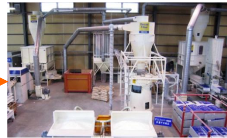
新聞紙をリサイクルしてつくるセルロースファイバー断熱材
