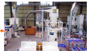
新聞紙をリサイクルしてつくるセルロースファイバー断熱材
